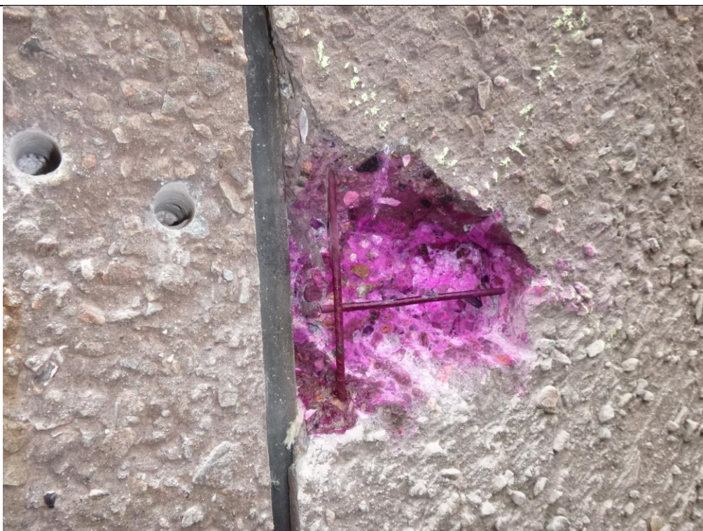
Foto 9: (P1090454.JPG). Påføring af phenolphthalein viser, at betonen praktisk talt ikke er karboniseret. Til venstre ses borehuller for bestemmelse af den fortykkede del af elementet og isolering i venstre hul.
